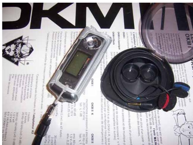
*Matériel utilisé pour les enregistrements sur le terrain : un baladeur MP3, et deux microphones électrets OKM II K (capsules rouge et bleu sur la photo).*
