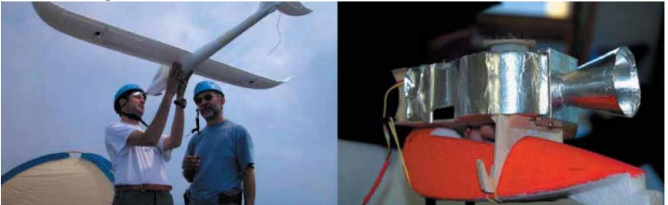
*A gauche, exemple de planeur motorisé et télécommandé qui a été utilisé avec succès, pour échantillonner des panaches de cendres au Stromboli ; à droite détail de l'appareillage d'échantillonnage des cendres, capable de prendre jusqu'à quatre échantillons différents durant un même vol. Il peut-être télécommandé à distance (ouvertures / fermetures).*
