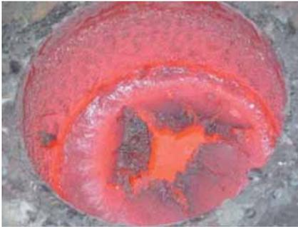
*Expérimentation sur des échantillons de basaltes en fusion (1150 °C) avec des teneurs en cristaux variables, fragmentés par un flux de gaz : en haut avec 40% de moins de cristaux que le bain en fusion du bas montre un comportement plus ductile (« plus fluide ») que celui de l'image du bas montrant une fragmentation plus anguleuse, pour les mêmes conditions expérimentales (température, flux de gaz, etc.).*
