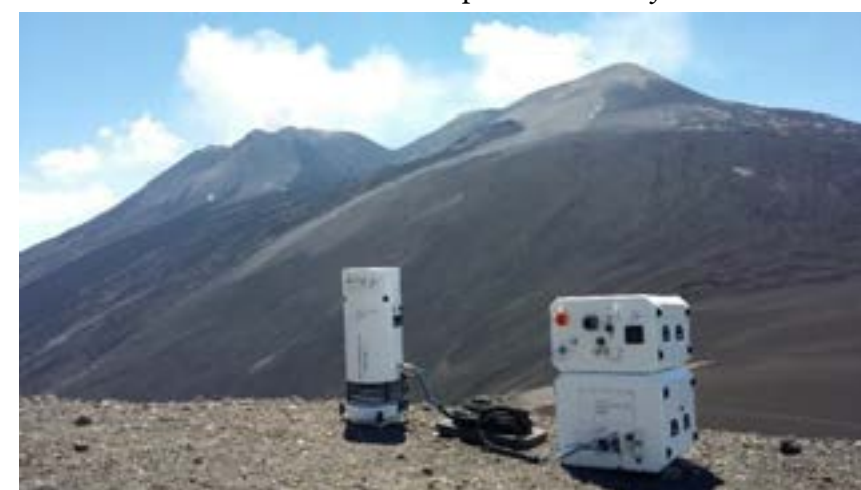
Fig. 1 Photo d'un gravimètre quantique monté sur le volcan Etna en août 2020 à l'observatoire de Pizzi Deneiri. Le module situé à gauche est la tête de capteur, qui contient la chambre à vide au sein de laquelle est réalisée la mesure de g . Le module situé à droite est le système laser et l'électronique de contrôle
